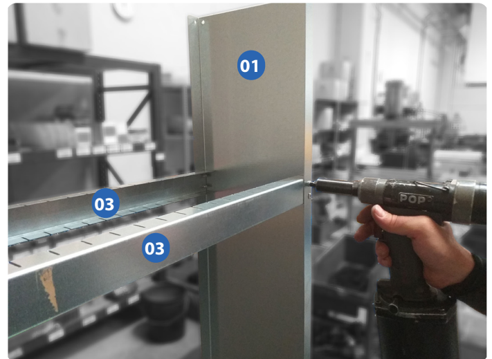
8.- Una vez bien posicionadas estas chapas, insertar el segundo fijador.
