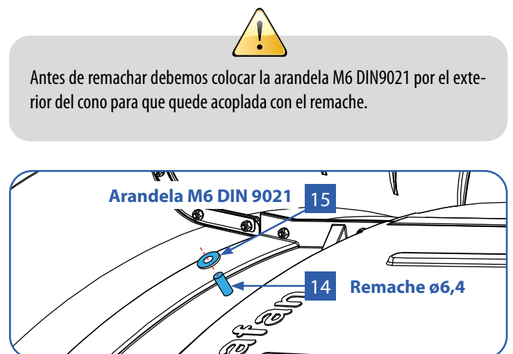
Fig. 9.21. Tornillería (parte exterior del cono).
