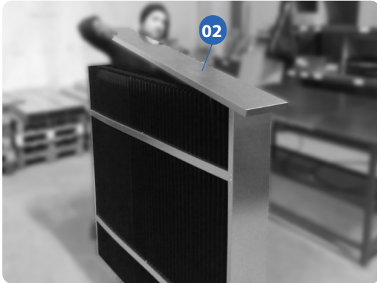
19.- Colocamos el techo, de tal manera que éste quede por fuera de las chapas laterales.
