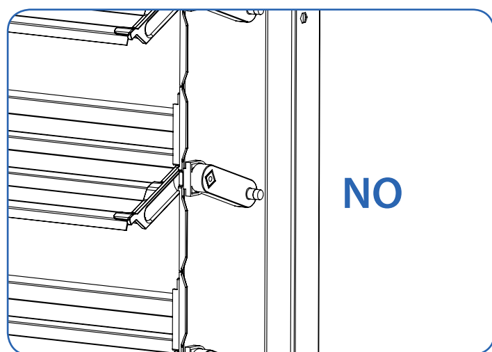
Fig. 30. No colocar las pinzas lamas con las lamas abiertas.
