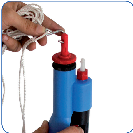
Figura.20. Introducir el gancho en el agujero de la parte superior del eje.
