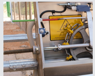
Sistema de reparto de pienso combinado, mediante transporte por espiral desde el silo a los circuitos de cadena.
