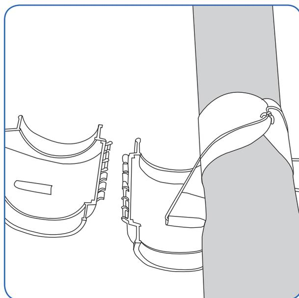
Al terminar el montaje de la T de descarga (según como muestra el dibujo), cerciorarse de que los movimientos del sistema son suaves. Si se presentan dificultades en el movimiento, será necesario desmontar la T de descarga y asegurarse de que todo estaba montado correctamente.
